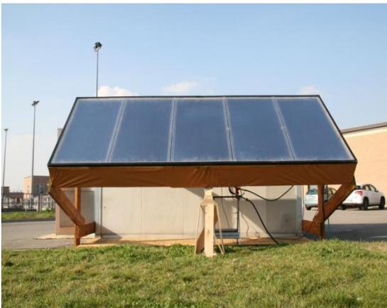
Anche nel caso di un pannello solare termico è importante controllare l'accensione della pompa di circolazione dell'acqua in funzione della differenza di temperatura tra i tubi esposti al Sole e il serbatoio. Senza contare l'importanza di una raccolta di dati destinati alle valutazioni sull'efficienza del nostro impianto.
