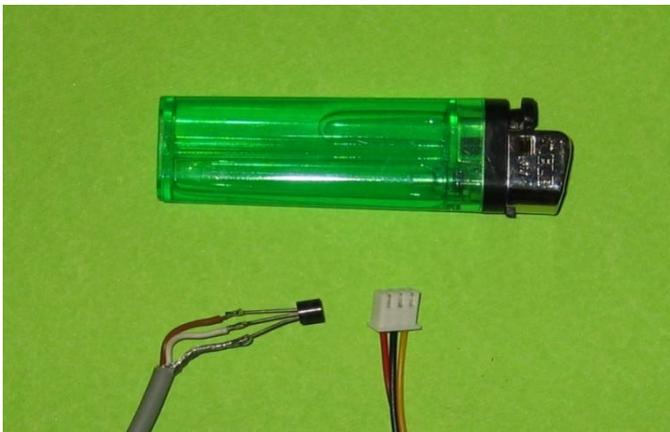
Ad esempio, per misurare una temperatura, si può usare un piccolo circuito integrato (chip) già tarato, che, collegato ad Arduino con solo tre fili, risponde, ad un apposito comando digitale, con una serie di byte che rappresentano il valore numerico della temperatura. Il tutto è gestito dal programma con poche funzioni.
