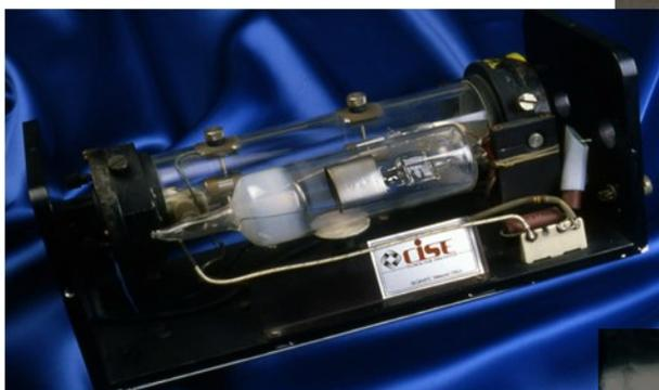
Fig.7 – Primo laser stabilizzato in frequenza
