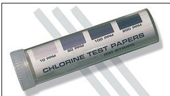
Il metodo delle cartine test, economico e stabile nel tempo, è largamente usato, non solo per il pH (acido/base), ma anche per la determinazione di altre sostanze presenti nell'acqua, come gli idrocarburi, il cloro, il solfuro d'idrogeno. Dal colore assunto della cartina, una volta immersa nell'acqua, è possibile risalire alla concentrazione di queste sostanze, mediante confronto con una tabella allegata alla confezione dal fabbricante.
