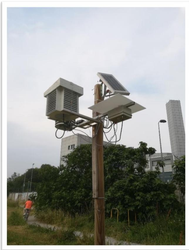
Foto 9 – Stazione meteo installata presso la cascina S. Ambrogio a Milano. Si possono vedere chiaramente il piccolo pannello solare e la “capannina” autocostruita con laser cut e legno compensato.
