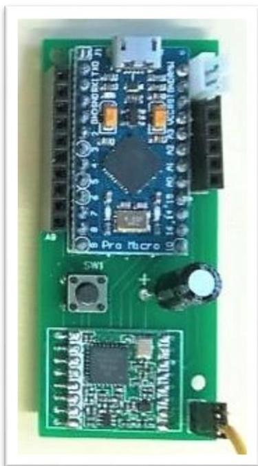
Figura n. 4 – Scheda ProMicroLoRa costruita dal socio Paolo Bonelli. Nella sua parte alta è visibile il modulo programmabile, compatibile con la più famosa scheda Arduino, in basso c'è il modulo radio LoRa ad esso collegato. La scheda può essere alimentata con una batteria di tensione da 4 a 12 V.
