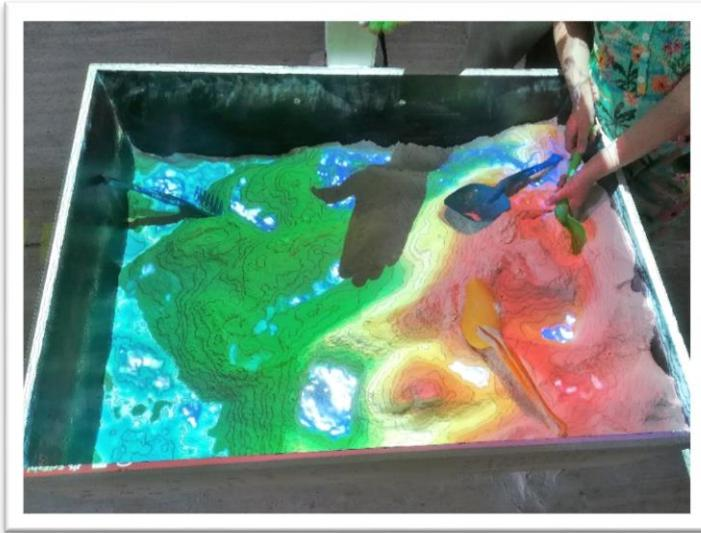
Foto n. 2 – Sabbiera con proiezione di topografia
