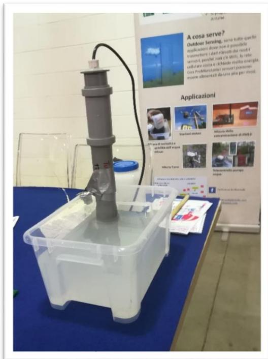
Foto n. 6 – Misuratore della torbidità dell'acqua con trasmissione dei dati a distanze tramite la scheda ProMicroLoRa
