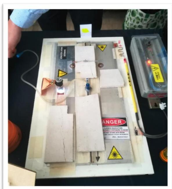
Foto n. 1 - Laser a gas senza tubo a vuoto
