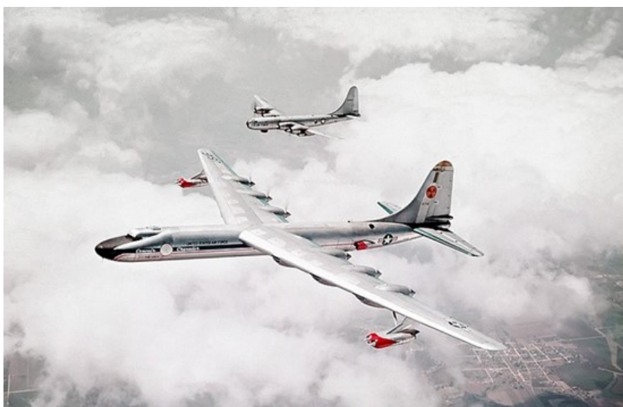
Figura 14 – Il Convair BN-36H in un test di volo affiancato da un Boeing B-50 Superfortress .
