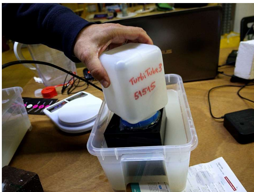
Figura 3 – Calibrazione di uno strumento per la misura della torbidità dell'acqua durante un workshop presso WeMake di Milano
